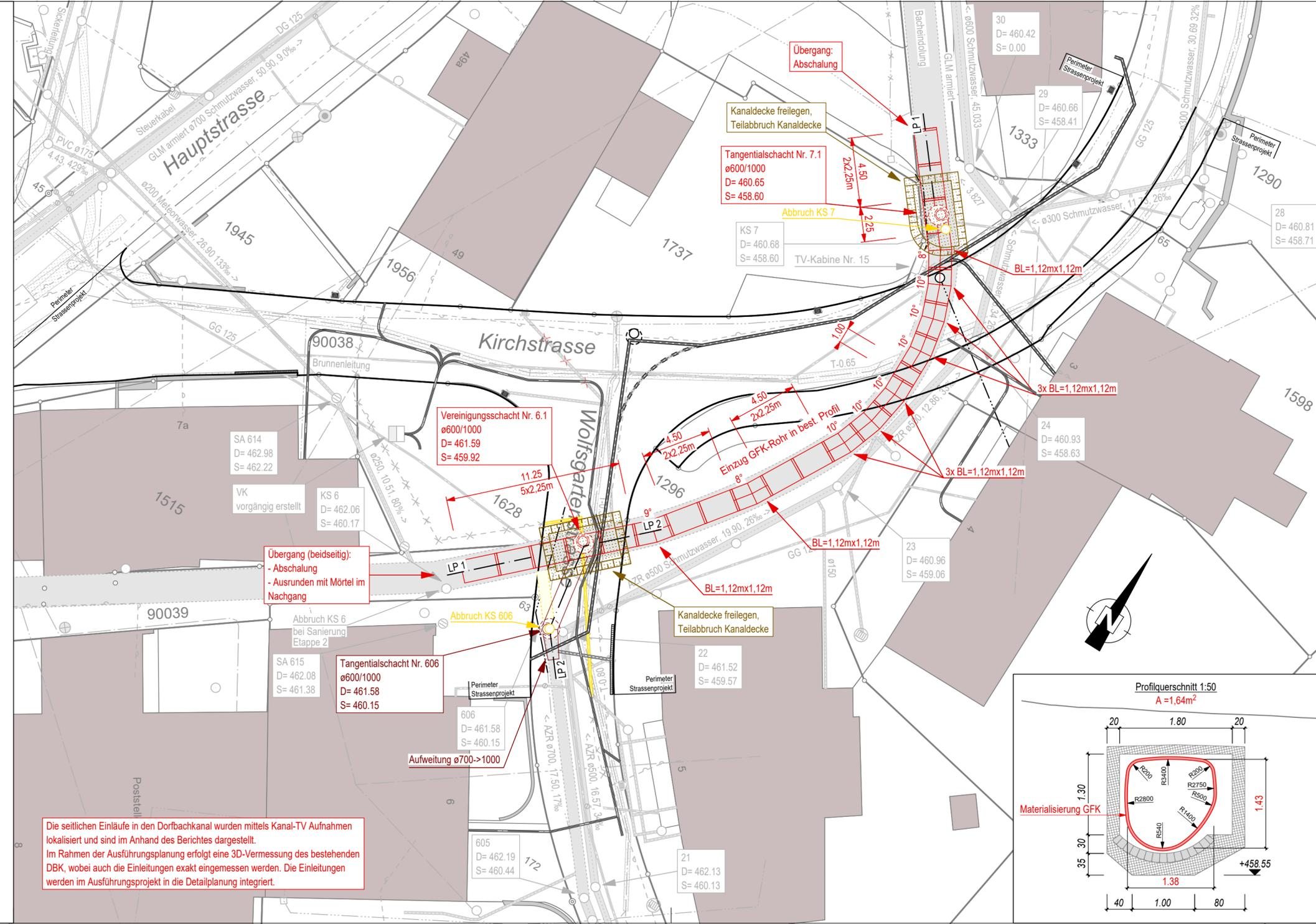
Die seitlichen Einläufe in den Dorfbachkanal wurden mittels Kanal-TV Aufnahmen lokalisiert und sind im Anhand des Berichtes dargestellt. Im Rahmen der Ausführungsplanung erfolgt eine 3D-Vermessung des bestehenden DBK, wobei auch die Einleitungen exakt eingemessen werden. Die Einleitungen werden im Ausführungsprojekt in die Detailplanung integriert.
