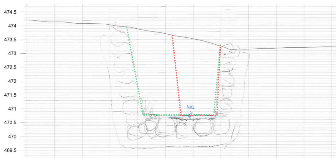
Abbildung 7: Abflussquerschnitt Ausdolung Abschnitt 1 (rot: hydraulisch erforderlicher Querschnitt, grün: Querschnitt mit ökologischer Aufwertung der Sohle)
