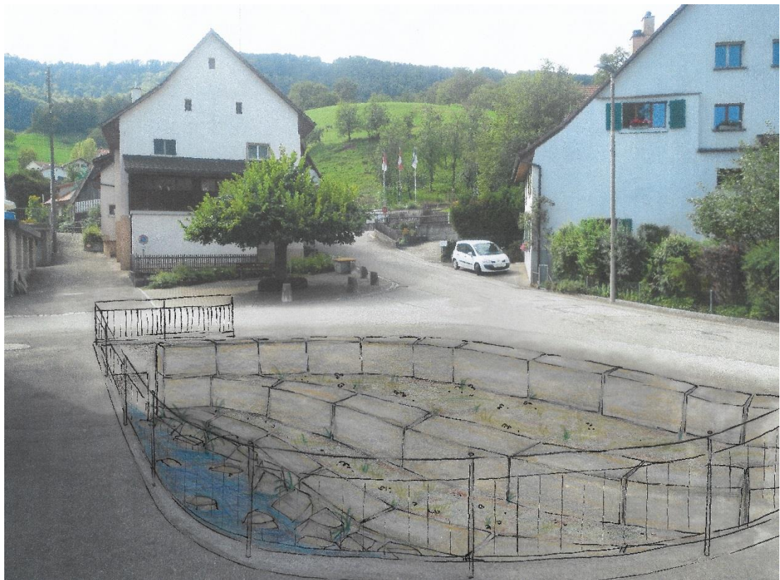
Abbildung 9: Visualisierung Platzgestaltung mit ausgedoltem Bach
